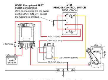
**Deutsch DTM Connector Termination**
